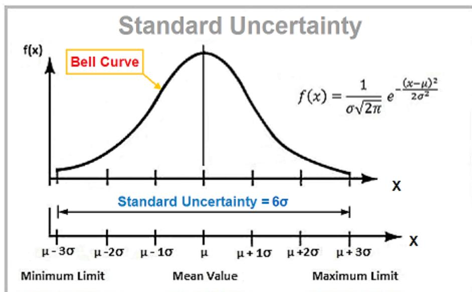
اگر  $\mu$  میانگین نتایج اندازه گیری باشد، بنابر این  $X = \mu \pm 3\sigma_x$
