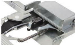
Patentiertes System STEMLOCK für die manuelle Verriegelung zum Schutz vor versehentlichem Ein-/Ausfahren.
