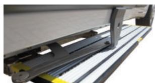
Total Ausfahren von Trittstufe durch minimalen Hub der Fahrzeugtür.
